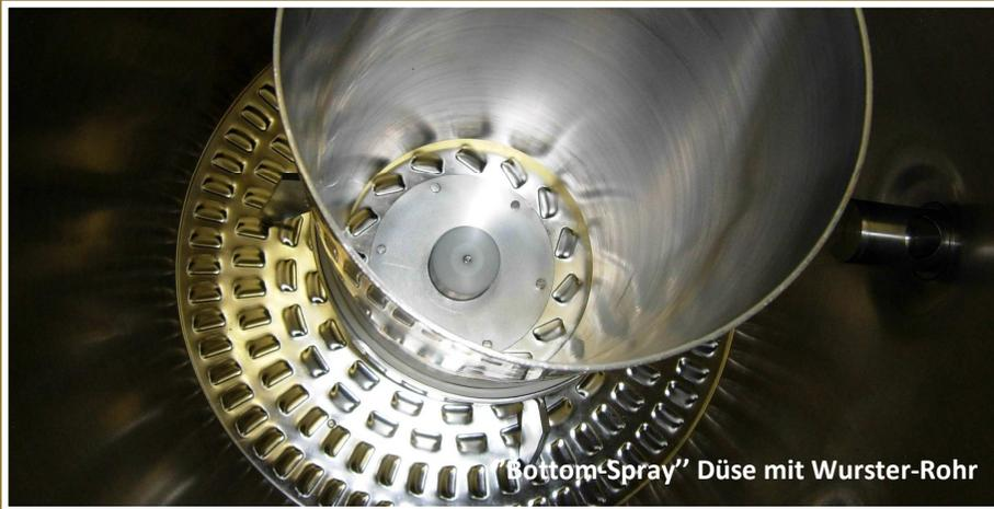
"Bottom-Spray" Düse mit Wurster-Rohr
